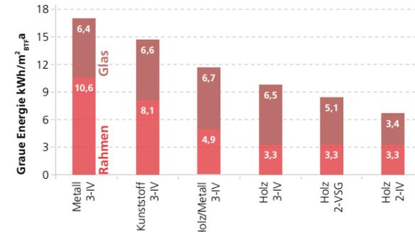
Wieder zeigt sich, dass jene Materialien mit einem hochveredelnden Herstellungsprozess am meisten graue Energie enthalten. Metall- und Kunststoff-Rahmenprofile sind gegenüber jenen aus Holz deutlich benachteiligt. Die graue Energie der Verglasung bleibt praktisch konstant und ist nahezu unabhängig vom Rahmenmaterial.
