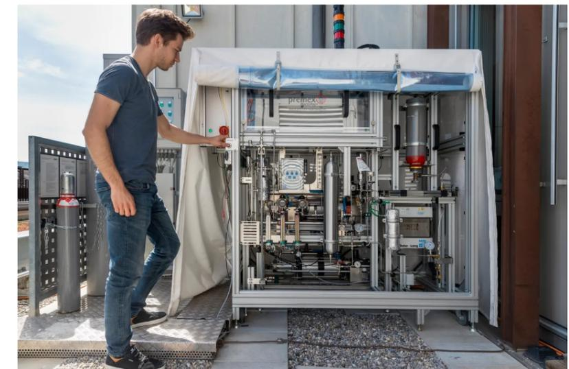
Das Synthesegas, das in der Anlage produziert wird, lässt sich in flüssige Treibstoffe wie Methanol oder Kerosin weiterverarbeiten. (Bild: Alessandro Della Bella / ETH Zürich)
