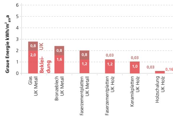
Glas ist nur in Kombination mit einer Unterkonstruktion aus Metall sinnvoll und schneidet am schlechtesten ab. Eine Holzschalung wird dagegen immer auf einer Unterkonstruktion aus Holz befestigt. Zwischen diesen beiden Fassadenkonstruktionen liegt ein Faktor von etwa 15! Das zeigt die grosse Bedeutung einer bewussten Materialwahl. Ferner lässt sich die Differenz der Unterkonstruktionsarten direkt an den zwei Beispielen mit Faserzementplatten ablesen und beträgt 0,8 kWh/m²<sub>BTf</sub>a.
