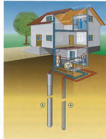
Bild 3.25: Sole-Wasser-Wärmepumpenanlage mit Erdsonden
