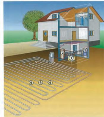
Bild 3.26: Sole-Wasser-Wärmepumpenanlage mit Erdkollektoren
