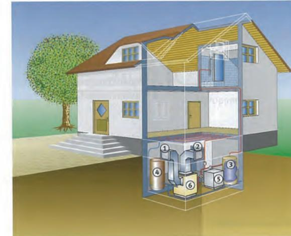
Bild 3.28: Luft-Wasser-Wärmepumpenanlage
