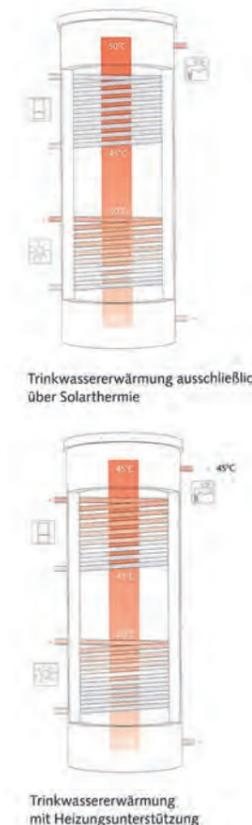
Auswahl möglicher Integration und Anordnungen von Solarthermie am Gebäude
