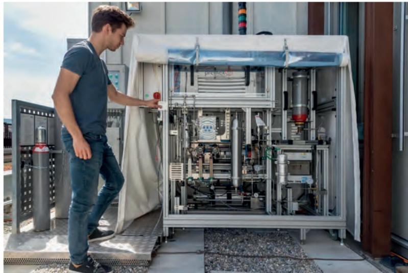
Das Synthesegas, das in der Anlage produziert wird, lässt sich in flüssige Treibstoffe wie Methanol oder Kerosin weiterverarbeiten. (Bild: Alessandro Della Bella / ETH Zürich)
