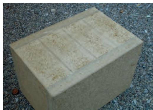
Die vollständig aus Strohlplatten bestehende Aussenwand ist wie ein Sandwich aufgebaut, welches im Verbund als statisches Scheibenelement wirksam wird: Die dichtere Innen- und Aussenbeplankung (je 4cm) umschliesst die poröseren, wärmeisolierenden Elemente aus Stroh (17cm).
