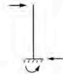
Eingespannte Stützen ermöglichen die Horizontallastabtragung in allen Richtungen.
