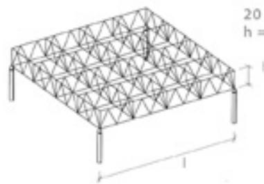
Diagonalstäbe, die deshalb in der Regel als Zugstäbe ausgeführt werden. Druckbeanspruchte Gurtstäbe sind gegen Ausknicken aus der Fachwerkebene zu sichern. Durch die Addition von Dreiecksmaschen in zwei Richtungen können ebene Raumfachwerke gebildet werden. Eine weitere Anwendungsmöglichkeit sind Stabwerkskuppeln und Gitterschalen.
