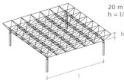
**Vordimensionierung Fachwerk-Trägerrost Stahl:**
